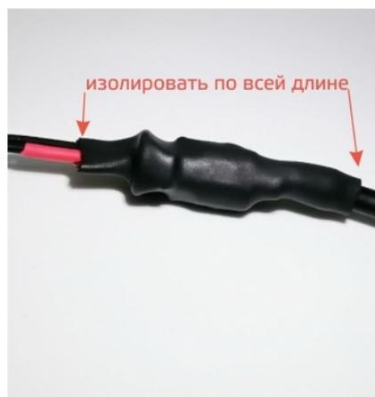
**ВАЖНО!** Для надежного соединения провести изолирование места подключения изоляционной лентой.
